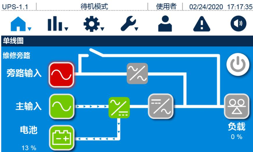
3) 以下画面表示 UPS 在经济模式下工作，逆变器在准备开启状态，负载由旁路供电。有关经济模式设定，请参阅 7.9.2 模式设定 及 6.2.5 经济模式开机程序。
