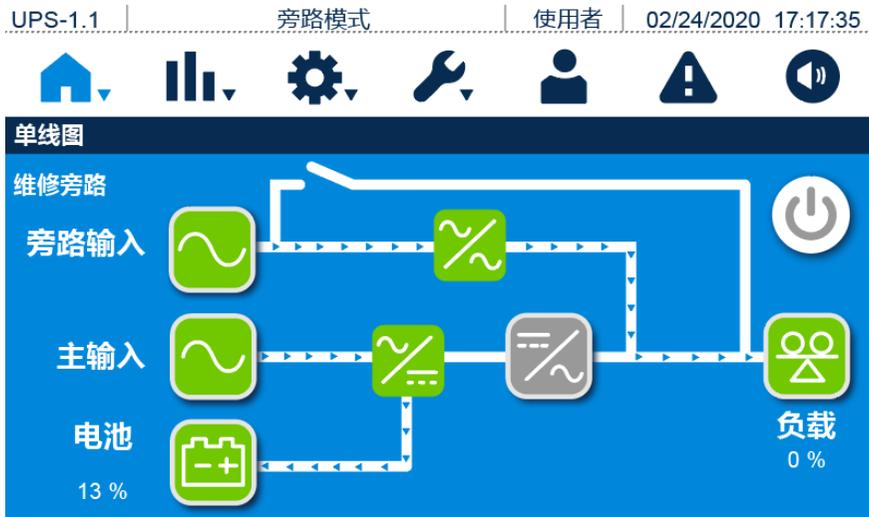
6) 以下画面表示 UPS 在频率转换模式下工作，限制旁路输出。有关频率转换模式设定，请参阅 7.9.2 模式设定 及 6.2.6 频率转换模式开机程序。
