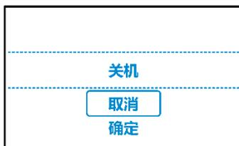
使用向上/ 向下键 ( ⬆ / ⬇ ) 选择'确认'并按下输入键 ( ⏻ ) 后, 逆变器将会关闭, UPS 将转为待机模式或旁路模式。
