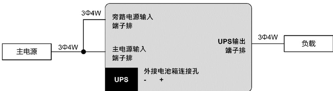
(图7-9: UPS 配线图\_单回路三相输入 & 三相输出)
