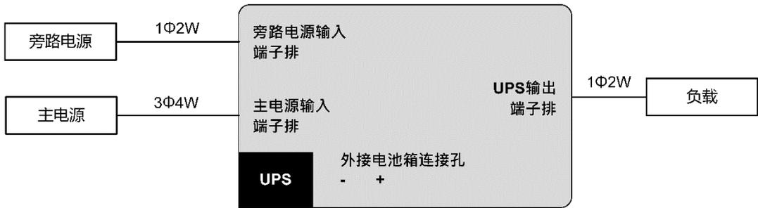
(图 7-7: UPS 配线图\_ 双回路三相输入 & 单相输出)
