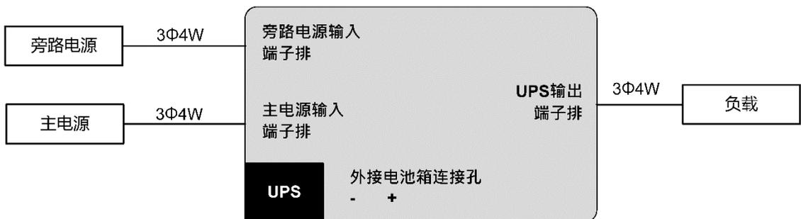
(图7-11: UPS 配线图\_ 双回路三相输入 & 三相输出)
